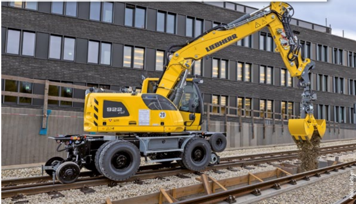
La pelle ferroviaire A 922 Rail Litronic est utilisée aussi bien pour la construction de voies que pour les travaux classiques de terrassement.
