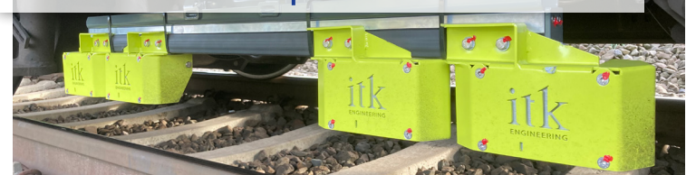
Localisation grâce à la modification du champ électromagnétique.
