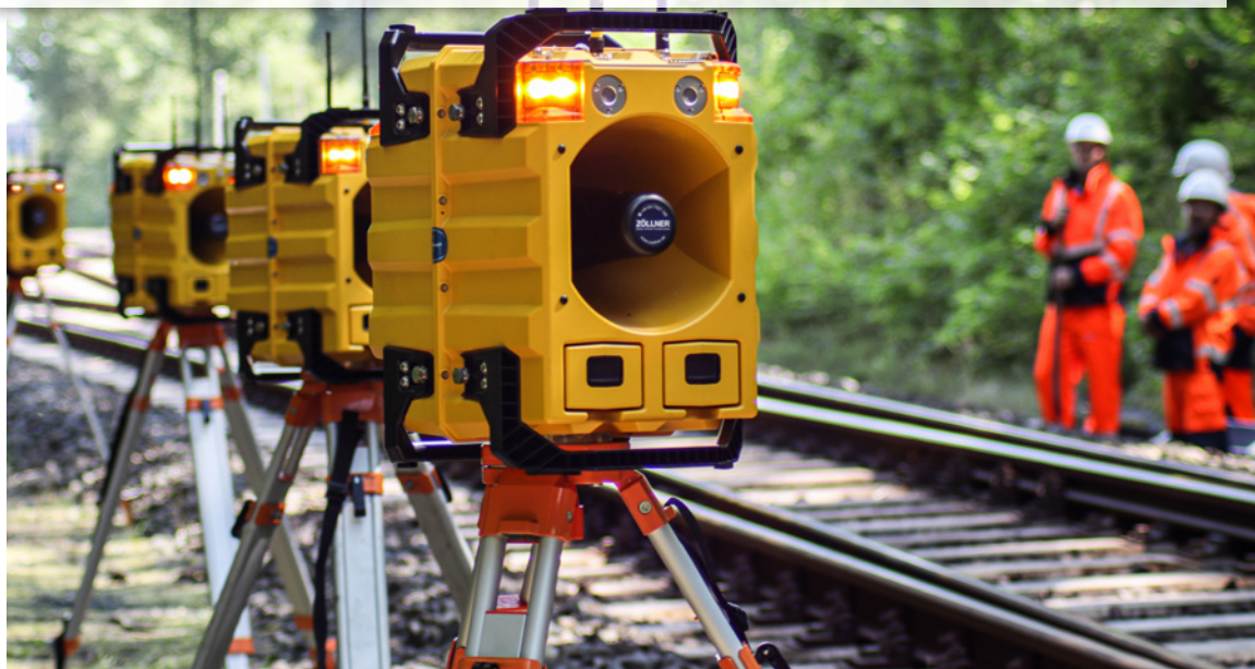
Un système automatique d'alerte sonore et lumineuse prévient de l'approche d'un train
